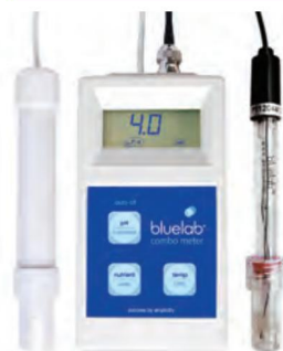
Úspěšná kalibrace pH 7 a pH 4
