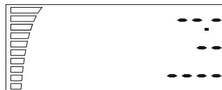
Em seguida, começa a inicialização do sensor e se o ecrã ficar nessa posição, isso significa que existe um problema com o sensor ou a sua conexão. Nesse caso, deverá retornar o ventilador para a reparação.
