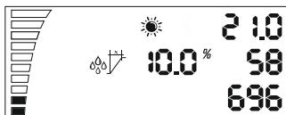
Inställning av minimal hastighet om dagen. Längst ner till vänster kan du se den aktuella inställningen av hastheten.
