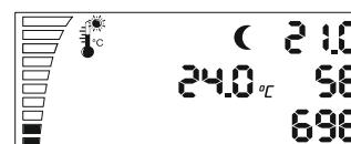
Diese letzte Einstellung ist die Umschaltzeit zwischen Tag- und Nacht Modus. Wenn der Lichtsensor den Umschaltpegel erreicht hat beginnt das Rückwärts zählen in Sekunden vom eingestellten Wert. Wenn das Rückwärts zählen der eingestellten Zeit ohne einen Lichtunterbruch zustande kommt wird der Regler die neue Einstellung von Tag/Nacht oder Nacht/Tag vornehmen. Sollte die Rückwärts-zählung unterbrochen werden muss diese wieder von Anfang an begonnen werden.
