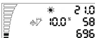
La regolazione dell'isteresi dell'umidità dell'aria durante il giorno e' la stessa di quella dell'isteresi della temperatura dell'aria descritta qui' sopra. Esempio: 10% rh e 60% d'umidità. Il ventilatore inizia a funzionare mentre c'e' il 60% d'umidità e +10% rh e finché c'e' il 70% di rh raggiunge la velocità massima.
