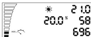
Nastavení minimální rychlosti v průběhu dne. V levé spodní části vidíte opravdové nastavení rychlosti.
