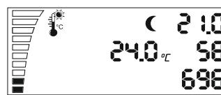
Deze laatste functie dient voor het omschakelen tussen dag- en nachtbedrijf. Wanneer de lichtsensor het niveau voor omschakelen bereikt, begint het aftellen afhankelijk van de ingevoerde seconden. Na het aftellen zal de regelaar automatisch omschakelen van nacht- naar dagbedrijf of omgekeerd, zonder stoppen van de lichtsensor.
