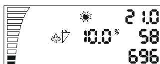
Nastavení na hystereze na vlhkost v průběhu dne tak, jak je popsána výše hystereze teploty. Příklad: 10% rh při 60% vlhkosti, ventilátor začíná pracovat na 60% vlhkosti i + 10% rh, a při 70% rh dosahuje maximální rychlost.
