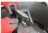
2 Aflojar el tornillo central del eje
