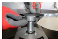
3 Ajustar las cuchillas a la altura deseada
