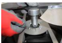
1 volver a apretar el tornillo bloqueador del eje
