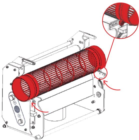
**4** Juntar la parte de comandos a la parte trasera de la peladora (A), (deben tenerse en cuenta las marcas adjuntas en la imagen de abajo). Los indicadores deben quedar alineados, si no es así, girar ligeramente el piñón sin fuerza. Una vez juntas tirar para dentro los posicionadores y girarlos 90° (EN NINGÚN CASO FORZAR LA PELADORA PARA CERRARLA).
