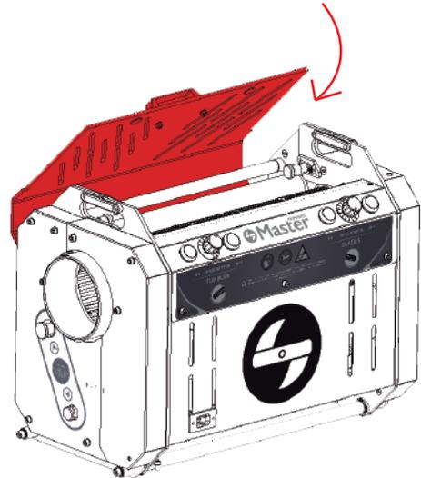
**6** Sobreponer la peladora (A) al aspirador (B). Hacer uso de las guías para colocarla correctamente.
