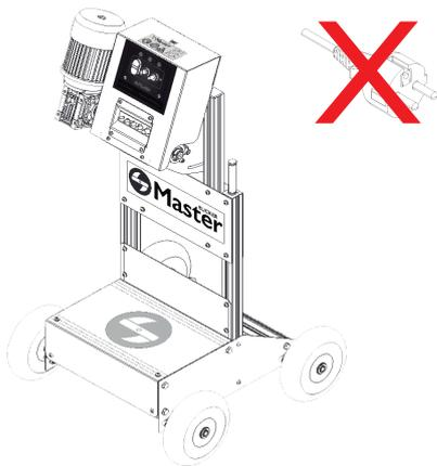
**2** Utilizar la llave allen nº6 (F) y desatornillar, los dos tornillos traseros marcados en la imagen, lo suficiente para que la máquina pueda bascular. No retirar del todo los tornillos, solo aflojarlos.
